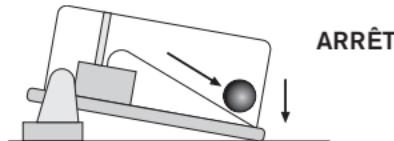
La bille est au repos, l'interrupteur est en mode arrêt.
