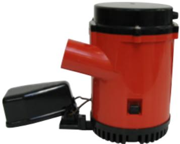
Der Schalter AS888 soll immer parallel zum Bilgengrund, mit dem Schwimmkörper direkt nach hinten weisend, angebracht werden. Den Schalter niemals niedriger als auf der Einlaßhöhe der Bilgenpumpe einbauen.
