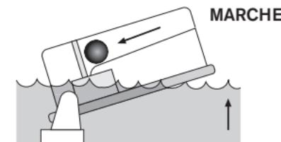
L'eau soulève l'interrupteur, la bille roule vers l'arrière, l'interrupteur commute en mode marche.
